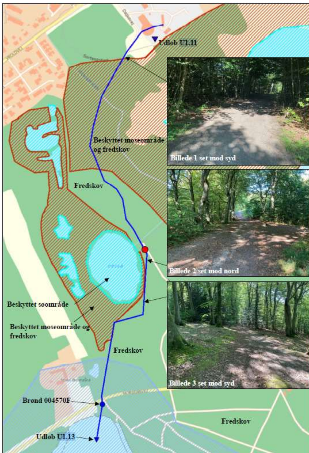
Figur 1. Placering af udløbsledning fra Skanderborg Centralrenseanlæg til Skanderborg Sø i U1.13. Figuren angiver de § 3-beskyttede naturområder langs udløbsledningen, samt billeder fra strækningen igennem skoven.
